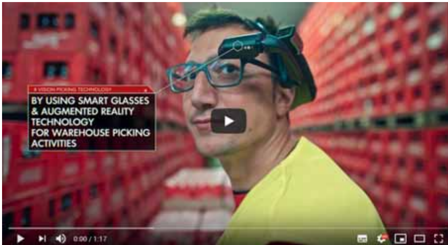
Рисунок 2. Умные очки дополняют визуальное восприятие созданной картинкой, проецируя изображение значимой информации на поверхность Источник: Coca-Cola HBC Россия
