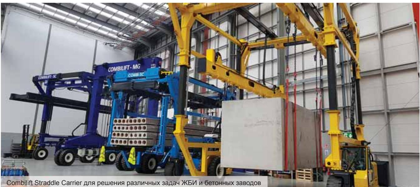
Combilift Straddle Carrier для решения различных задач ЖБИ и бетонных заводов
