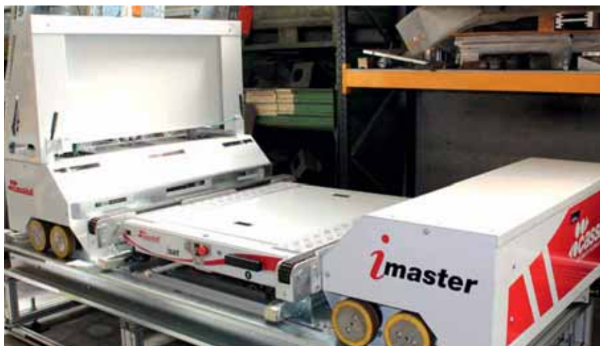
Радиошаттл представляет собой тележку с 4 роликами и электрическим приводом, снабженную системой лазерных датчиков для точного позиционирования внутри канала системы хранения.
