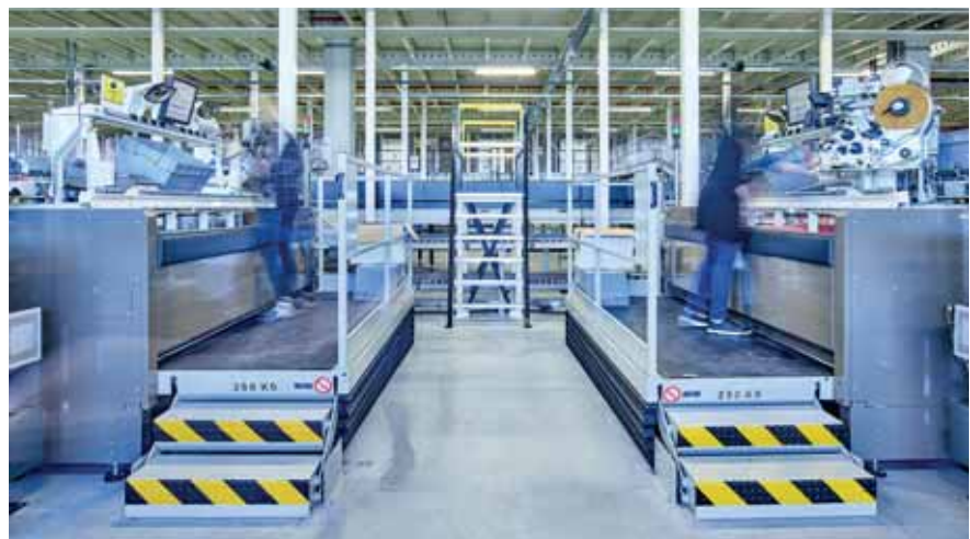
Комплектование по принципу «товар к человеку» на 28 рабочих местах Pick-it-Easy обеспечивает эргономичную обработку заказов за оптимальное время. На одной станции сотрудники могут обрабатывать 6 заказов одновременно
