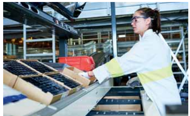
Интеллектуальные процессы с программной поддержкой easyUse: на экранах отображаются ресурсные и целевые контейнеры, а также штучное количество. На одном рабочем месте возможно обработать до 300 строк заказов в час.
