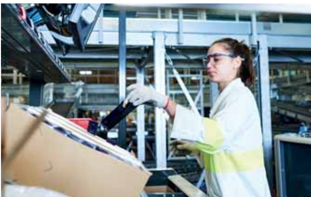
Принцип «товар к человеку» оптимизирует ручное комплектование: товары всегда подаются на эргономичной высоте и в правильной последовательности.
