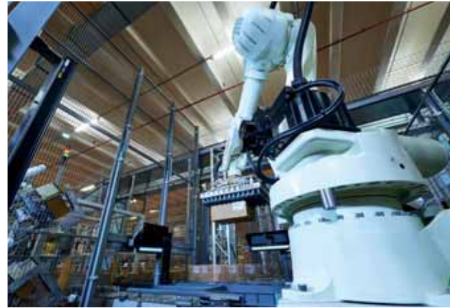
Роботы ставят коробки побольше прямо на конвейер, а коробки поменьше укладываются на поддоны. Это повышает плотность складирования в OSR Shuttle™.
