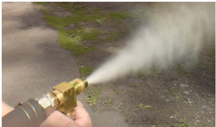
Рисунок 3. Натурные испытания самовсасывающего воздушно-топливного насоса-распылителя на воде Источник: архив авторов
