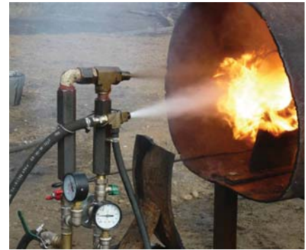
Рисунок 4. Практические испытания единой воздушно-топливной системы V-образного ДВС на стенде
