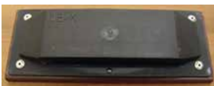
Рисунок 3. Защитный кожух для обеспечения механической защиты КБД Источник: фото автора
