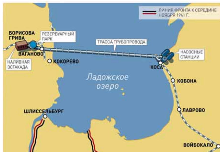
Рисунок 6. Схема трубопровода через Ладожское озеро, 1942 г. Источник: https://club.maghreb.ru
