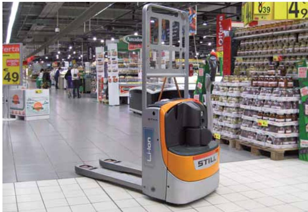
Литий-ионные батареи можно заряжать в любом месте и в любое время независимо от процента разряда, что позволяет избежать замены АКБ во время работы. Это обстоятельство обеспечивает максимальную гибкость используемой техники, а также снижает риск ее повреждения из-за неправильного использования батарей. Аккумуляторы достигают полного заряда в течение часа и до 50% уровня заряда за 30 мин, не требуют тех-
