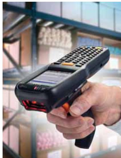
Datalogic Skorpio X3 создан специально для логистики и розничной торговли и является одним из самых надежных и популярных складских терминалов. Продуманная эргономика и высокая степень защиты от механических повреждений (падения с 1,5 м), пыли и влаги (IP64), современная электронная архитектура, и дисплей с диагональю 3,2" отвечают за быстродействие прикладного ПО и позволяют обеспечить комфортную работу персонала.
