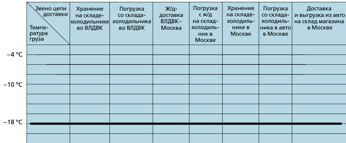
Рисунок 2. Температурный режим на различных звеньях цепи поставки при доставке рыбопродукции с Дальнего Востока в Москву при использовании в качестве транспортного средства рефрижераторного контейнера
