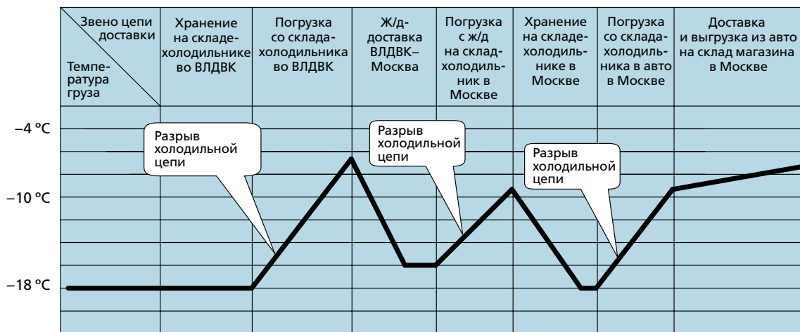
Рисунок 3. Температурный режим на различных звеньях цепи поставки при доставке рыбопродукции с Дальнего Востока в Москву при использовании в качестве транспортного средства рефрижераторного вагона
