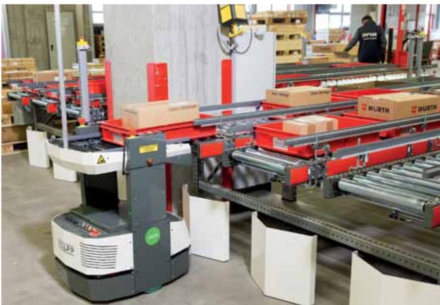
Передача контейнеров посредством OpenShuttle на конвейерное оборудование системы OSR Shuttle.
