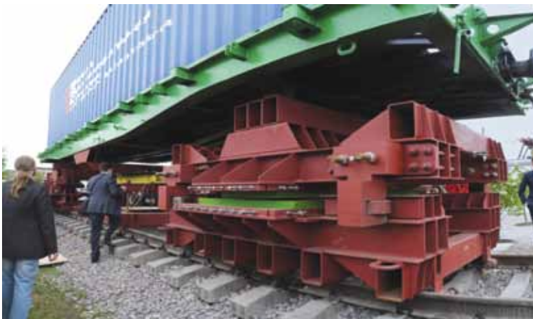
Рисунок 3. Контейнер на грузовой маглев-платформе (фото автора)
