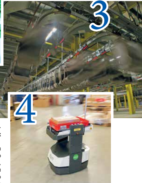
Рис. 4. Движение шаттлов Open Shuttle происходит автономно, без оптических и физических вспомогательных средств
