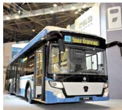
высокую энергоемкость и повышенный ресурс – до 5 тысяч циклов зарядки/разрядки, что позволяет увеличить суточный пробег машины до 200 км при использовании модульного решения по зарядке. Реализация этого решения подразумевает длительную ночную зарядку электробуса и 2–3 короткие подзарядки в течение 20–30 минут на конечных точках маршрута электробуса.
