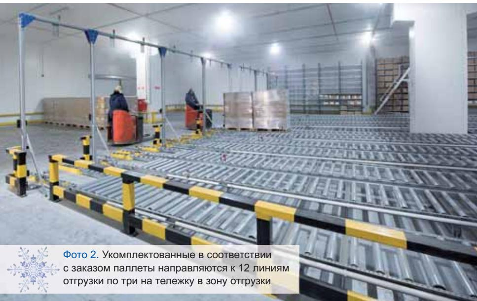
Фото 2. Укомплектованные в соответствии с заказом паллеты направляются к 12 линиям отгрузки по три на тележку в зону отгрузки
