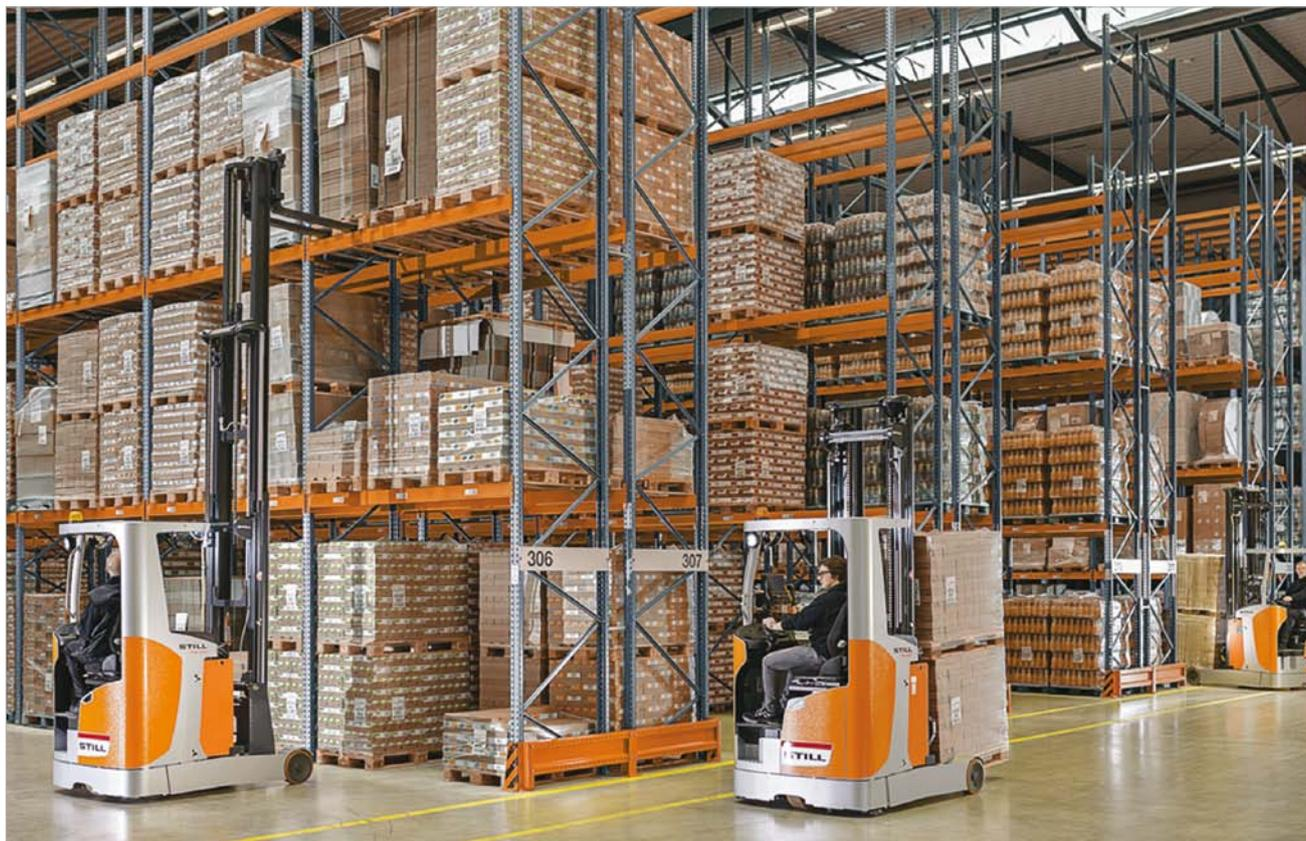
ной мачте с увеличенной жесткостью FM-X теперь легко поднимает грузы весом до 1000 кг на высоту до 13 м, позволяя оператору склада оптимально использовать складское пространство.
